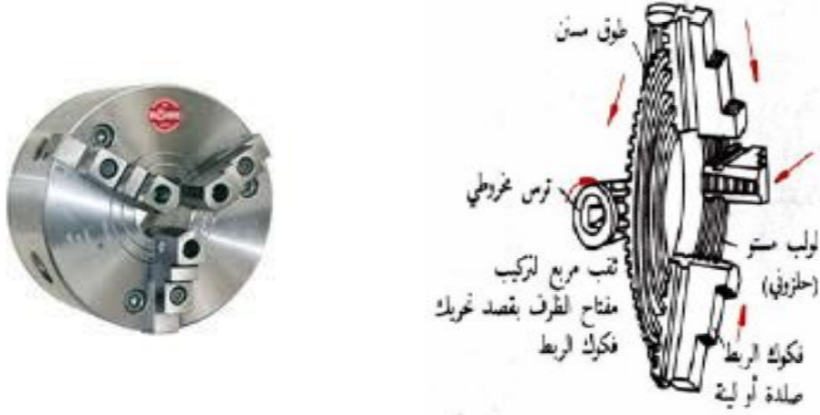
شكل (١٢) الظرف المركزي ذي ثلاث فكوك Three-jaw
